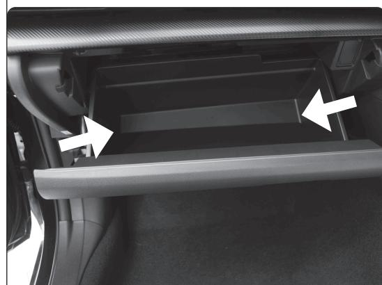
グローブボックスの両側を内側に押しながら手前方向に引いて、グローブボックスのストップバーを取り外します。
