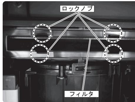
フィルタに付いているロックノブ(左右各2箇所)を解除して、フィルタを手前に引いて取り外します。
