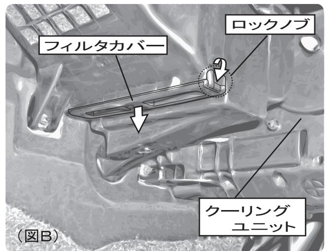
グローブボックスの下に潜り込み、(図A)クーリングユニットの左側にフィルタカバーが取り付けられていることを確認してください。(図B)ロックノブを解除し、フィルタカバーを取り外します。
