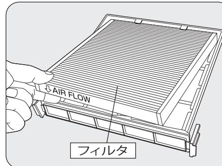
フィルタケースから汚れたフィルタを取り外し、新しいフィルタを取り付けます。
