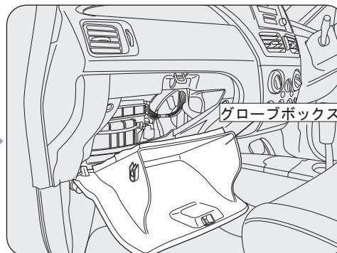
グローブボックスを開いてから、グローブボックスの両サイドを矢印方向に押し込みながら手前に引いて取り外します。
