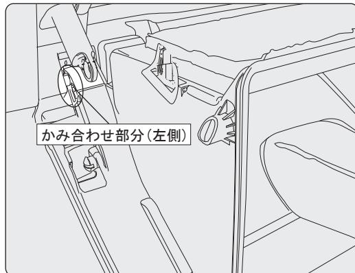
ストップバーを開放すると、グローブボックスの下部分が左右各1箇所ずつパネルと噛み合っているのが分かりますので、グローブボックス全体を持って手前に引くとグローブボックスを外せます。
