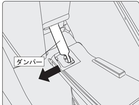
グローブボックスを開き、ボックス左側に付いているダンパーを左側に引いて開放します。
