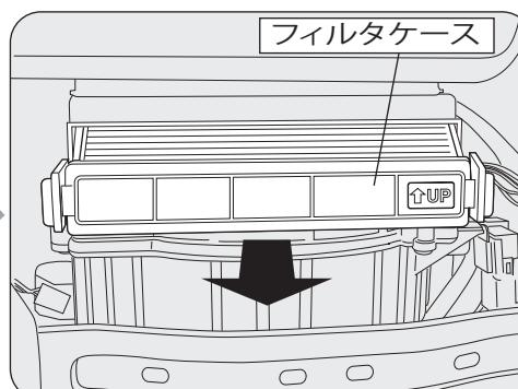
フィルタケースの両端に付いているロックノブ(左右各1箇所)を解除します。
