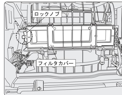
フィルタカバーの左側に付いているロックノブを外し、フィルタカバーを取り外します。
