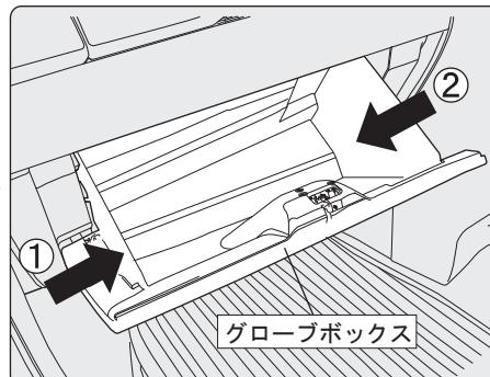
ボックス側面を図のように左側から片側ずつ内側に押しながら手前に引いて、ボックス奥の両サイドに付いているストップバーを開放します。
