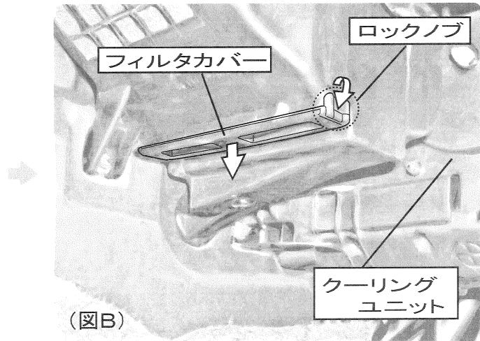
グローブボックスの下に潜り込み、(図A)クーリングユニットの左側にフィルタカバーが取り付いていることを確認してください。(図B)ロックノブを解除し、フィルタカバーを取り外します。
