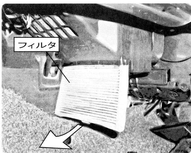
汚れたフィルタを取り外し、新しいフィルタを取り付けます。
