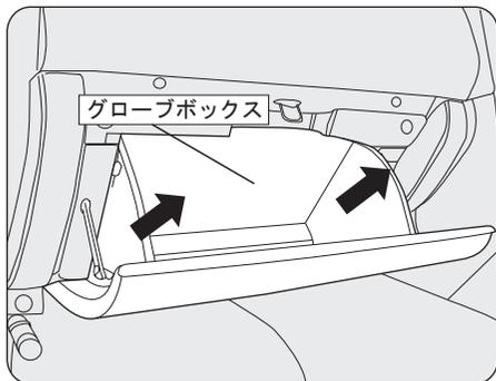
グローブボックスを手前方向に片側ずつ引いて、グローブボックス下部の嵌合部分(左右各1箇所)を取り外し、グローブボックス全体を取り外します。
