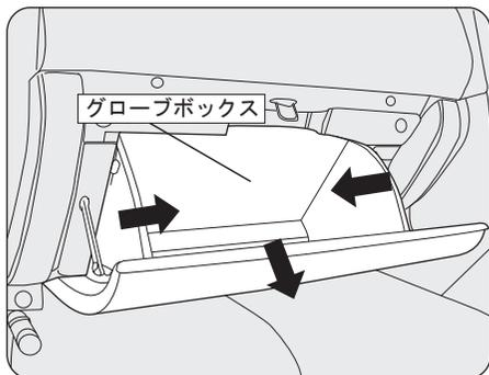
グローブボックスを開いて、ボックスの両サイドを内側に押しながら手前に引いて、ボックス奥のストッパー(左右各1箇所)を開放します。
