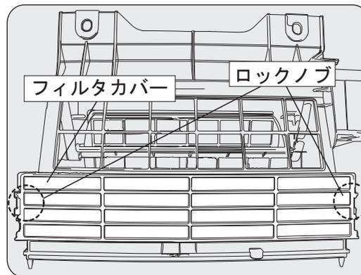
フィルタカバーの両側に付いているロックノブを解除してフィルタカバーを取り外します。
