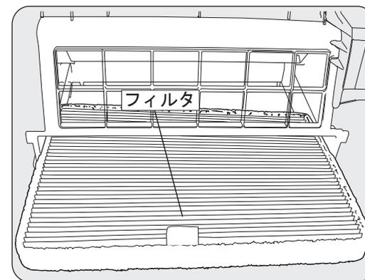
汚れたフィルタを取り出して、新しいフィルタと交換します。
