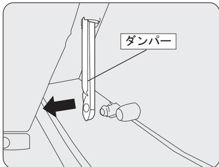
グローブボックスの左側に付いているダンパーを左に引いてグローブボックスから外します。
