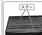
フィルタの左右に黒または白色のステアが付いている面が表側になりますので、ステアの付いている面を上にしてフィルタを装着してください。ステアが手前・奥になるようにセットしてください。
