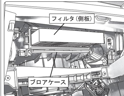
汚れたフィルタを引き出して、新しいフィルタと交換します。フィルタの側板が手前・奥になるようにセットしてください。
