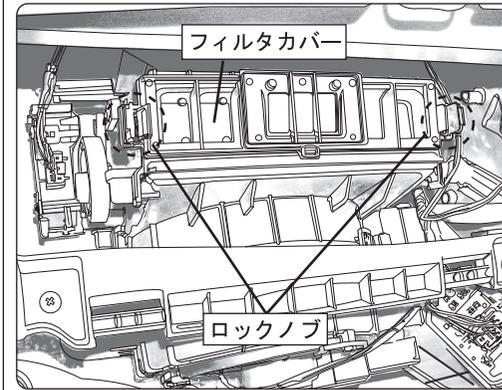
フィルタカバーの左右にあるツマミ(ロックノブ)を開放してフィルタカバーを取り外します。(お車によっては、フィルタカバーの形状が異なる物もあります)
