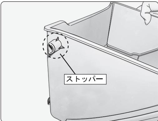
グローブボックスは左図のように突起状のストッパーが左右に付いていて、それぞれパネルに引っかかる仕組みになっています。この突起状のストッパーを損傷しないように、またグローブボックス下のはめ込む部分も損傷しないようにご注意ください。
