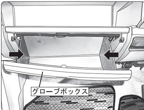
グローブボックスの左右内側を片側ずつ押して、グローブボックス両サイドに付いているストッパーを開放して、グローブボックスを取り外します。
