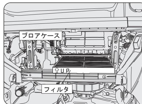
古いフィルタを取り出して、新しいフィルタと交換してください。フィルタの側板が左右に来るようにセットしてください。
