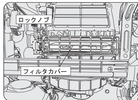
グローブボックスを外しますと、フィルタカバーが見えますので、左側のロックノブを解除してフィルタカバーを取り外します。
