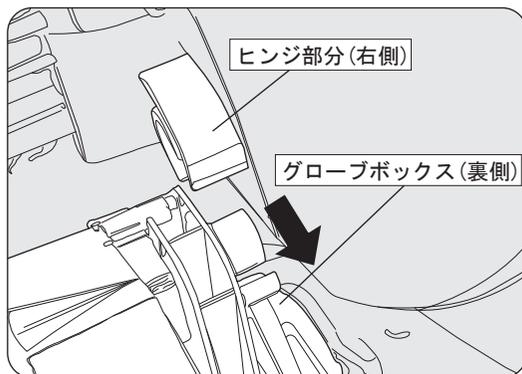
グローブボックスの下部は左右のヒンジ部分で固定されていますので上記手順でグローブボックスを開放してから手前に引くとグローブボックスを取り外す事が出来ます。
