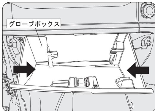
グローブボックスを開けてからグローブボックスの両サイドを片側ずつ矢印方向に押しボックス左右奥に付いているストッパーを開放します。
