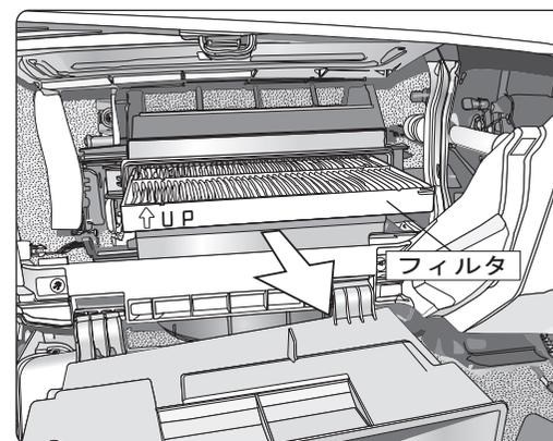
プロアケースから汚れたフィルタを取り外し、新しいフィルタを取り付けます。
