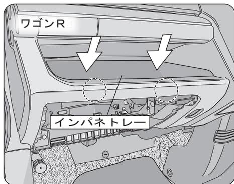
ワゴンRの場合はグローブボックスを外した後で上部のインパネトレイ(ネジ2箇所)を外します。ネジ(2箇所)は上図丸印部分の裏側にあります。トレイは矢印方向に押し外してください。
