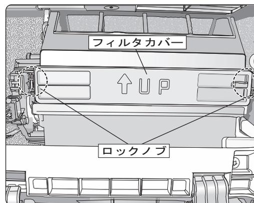
フィルタカバーの両端に付いているロックノブを外し、フィルタカバーを取り外します。
