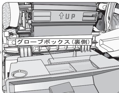
グローブボックスを開き、ボックス両側面を内側に押しながら、ボックスに付いているストッパーを片側ずつ解除した後、グローブボックスを手前に引いて取り外します。お車によってはストッパーを解除せずにグローブボックス全体を手前に引いて左右下側に付いているヒンジ部分を片側ずつ外してグローブボックスを取り外す車種(ワゴンR、ラパン)もあります。
