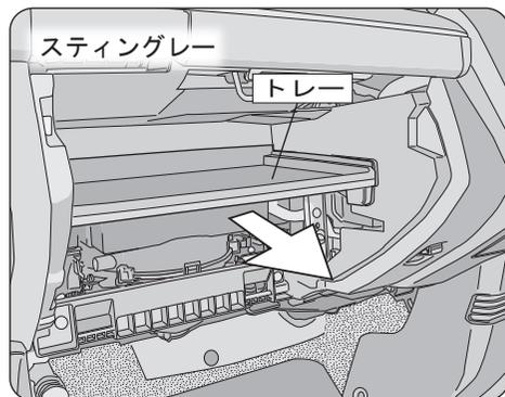
スティングレーの場合はグローブボックスを外した後で上部のトレイを手前に引いて外します。トレイの奥左右にツメ(各1箇所)が付いております。
