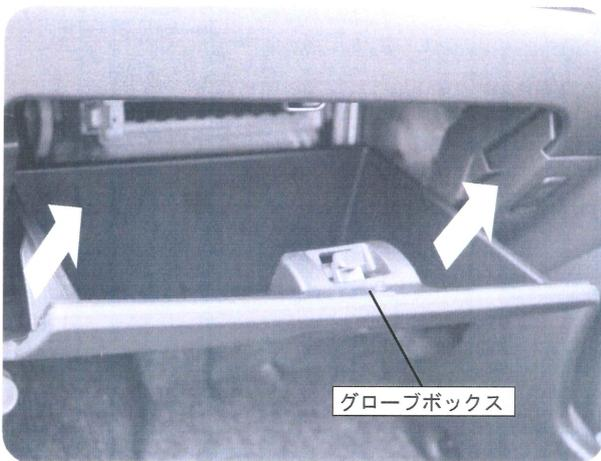
グローブボックスを開いて、グローブボックスの両サイドを片側ずつ(右側から)矢印方向(手前方向)に引くようにしてグローブボックス下の噛み合わせ部分(左右各1箇所)を外してグローブボックスを取り外します。
