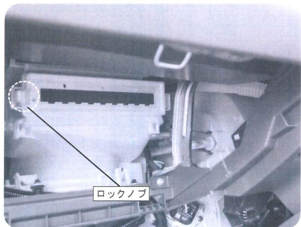
左側のロックノブを解除してフィルタカバーを取り外します。
