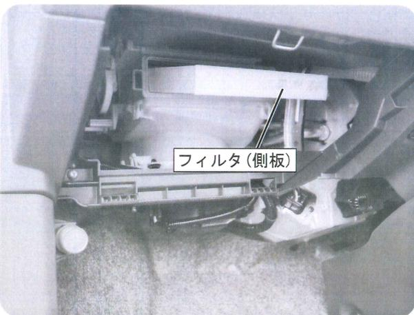
汚れたフィルタを取り出し、新しいフィルタと交換します。フィルタの側板が手前・奥の位置になるようにフィルタをセットしてください。
